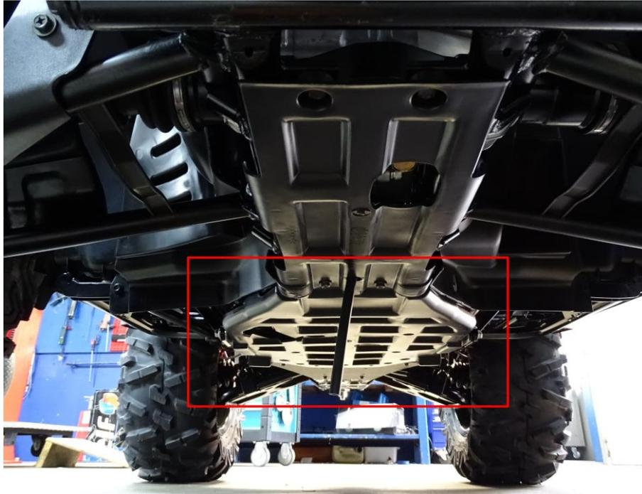
1. Entfernen Sie je nach Fahrzeugmodell den mittleren oder auch den vorderen Unterfahrschutz, die Montage erfolgt nur ohne dem Schutz.
