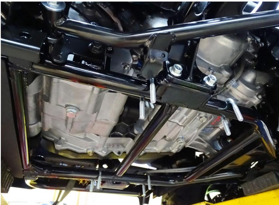
2. Legen Sie passende 4 Stück U-Bügeln wie abgebildet über das rechte und linke Rahmenrohr.
