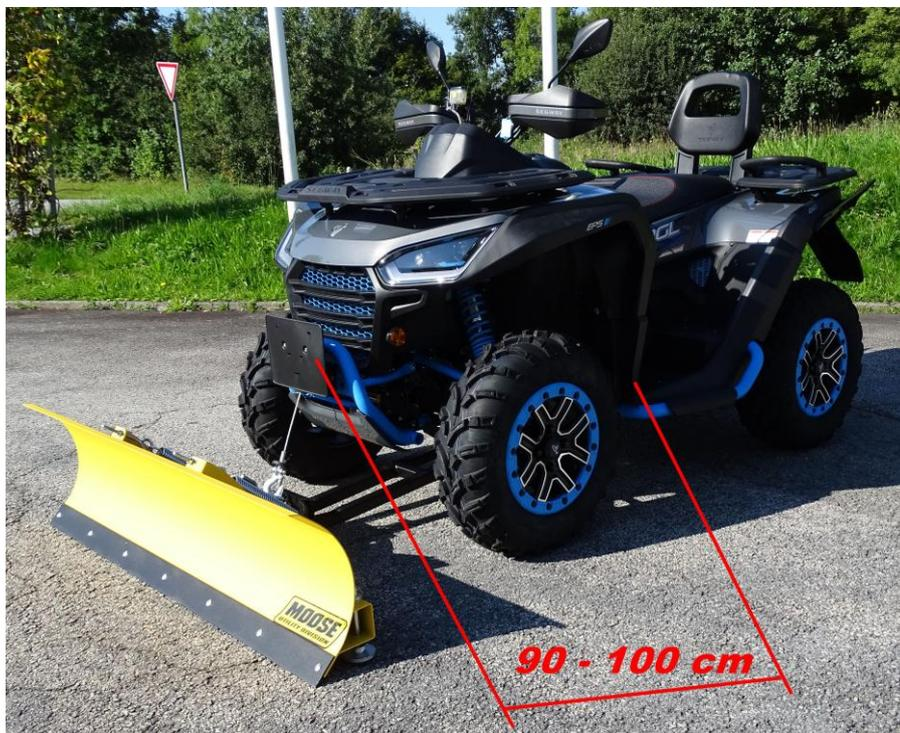
Diese Universelle Montageplatte ist für Moose Plow Schneeschildanlagen bei 95% der ATV und Quad Fahrzeuge passend.
