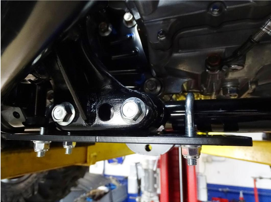
3. Halten Sie die Schneeschild Montageplatte unten an den Quad Rahmen und ziehen Sie die beigefügten Sicherungsmuttern M8 mit den Unterlegscheiben handfest mit den U-Bügeln an.
