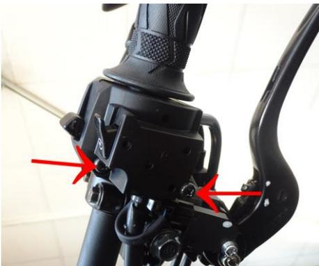
3. Entfernen Sie die 2 Schrauben der Lenkerschaltereinheit.
