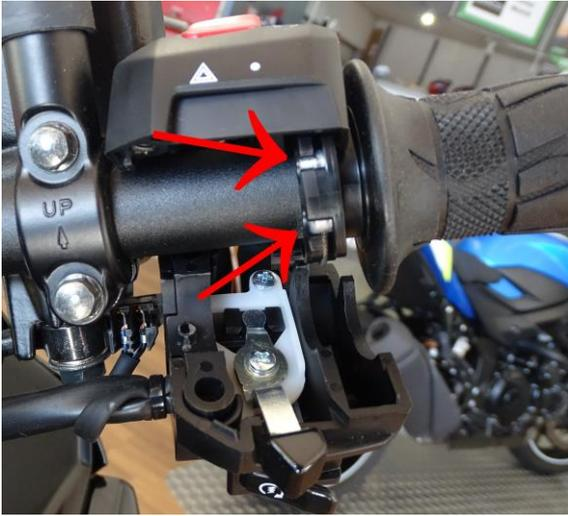
4. Demontieren Sie beide Gasseile und tauschen sie den Gasgriff gegen den TMP Performance Griff aus.
