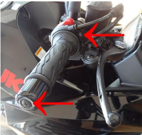
2. Entfernen Sie das Lenkergewicht und die Schraube der Gasseilhalterung.
