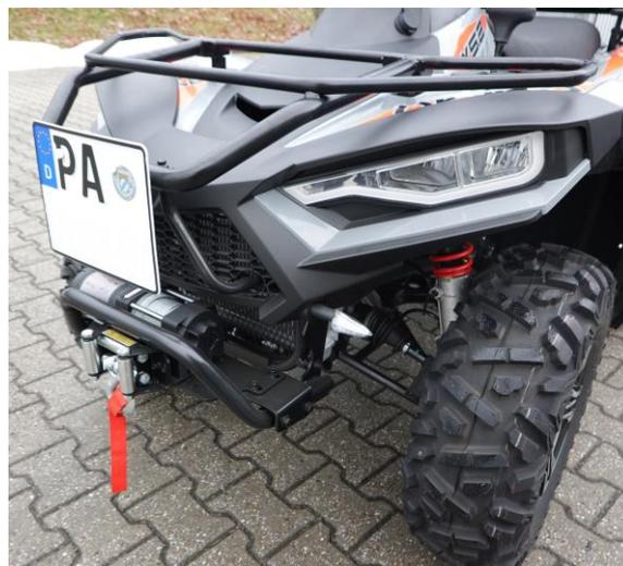
4. Letzter Schritt ist, die Abstände der Anschraubpunkte der Halterungen zu messen und am Kennzeichen zu markieren. Diese anschließend zu Bohren und das Kennzeichen am Fahrzeug anzubauen.
