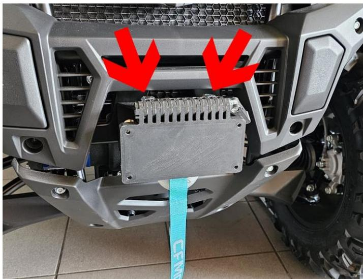
2. Positionieren Sie den Kennzeichenhalter über das Seilwindenfenster
