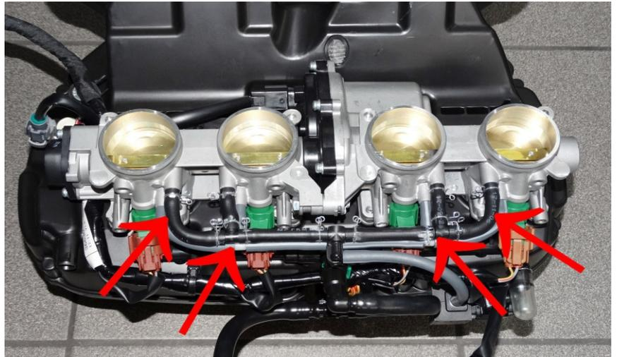
4. Die neuen EVAP Stopfen mit Klammern montieren
