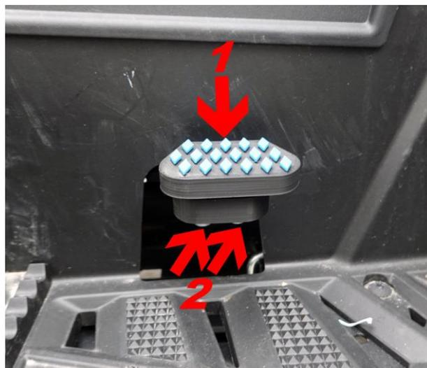
2. Bei korrekter Position können sie die obere Trittfläche (Bild „1“) in die vorgesehene Position einrasten.
