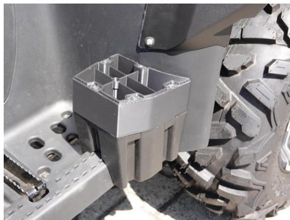
3. Danach können Sie die Beifahrer Trittbrettdeckung wieder auf die Erhöhung aufsetzen und mit den mitgelieferten langen Edelstahlschrauben miteinander verschrauben.
