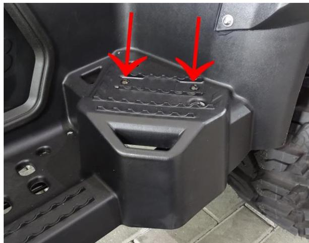
2. Montieren Sie die Distanzbügel mit den 2 Stück beigefügten Schrauben (silber). Achten Sie auf den oberen mittigen Lochversatz. Die größere Versatzfläche zeigt nach Fahrtrichtung vorne, auch die Distanzbügel sind mit L (Links) oder R (rechts) markiert.
