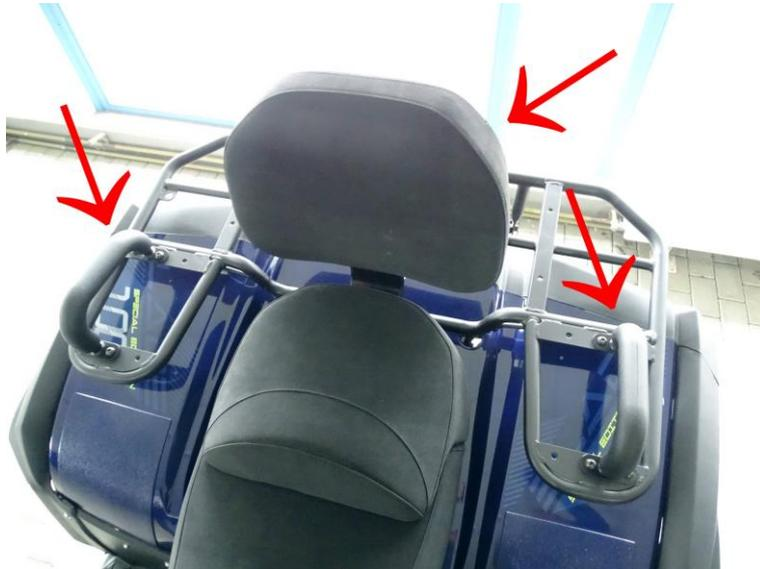
2. Da die Original Löcher im Koffer meistens nicht passgenau sind. Müssen alle gekennzeichneten Löcher auf 20 mm aufgebohrt (Stufenbohrer) werden.
