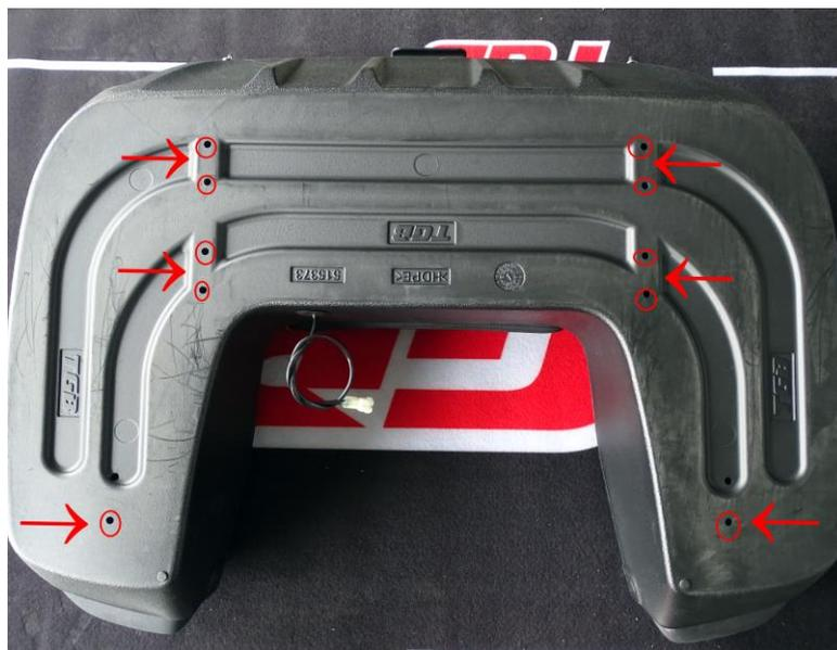
3. Positionieren Sie den Koffer auf das Quad, richten Sie den Koffer so aus, dass der Koffer mit 6 Bohrungen und den Anschraubpunkten am Gepäckträger übereinstimmen. Falls eine / zwei Bohrung immer noch nicht 100 % passen müssen diese Löcher zum Beispiel auf 22mm aufgebohrt werden.
