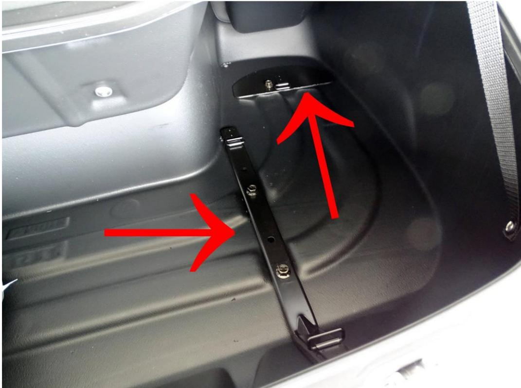
6. Schrauben Sie zu erst alle Schrauben Handfest an. Danach können sie die Schrauben bis zu 18 Nm Festziehen.
