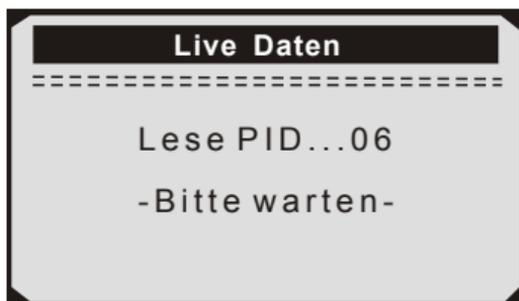
4) Um den vollständigen Datensatz anzuzeigen, verwenden Sie die AUFWÄRTS / ABWÄRTS-Taste, um im Menü Daten anzeigen die Option Vollständiger Datensatz auszuwählen, und drücken Sie die Taste EINGABE.
