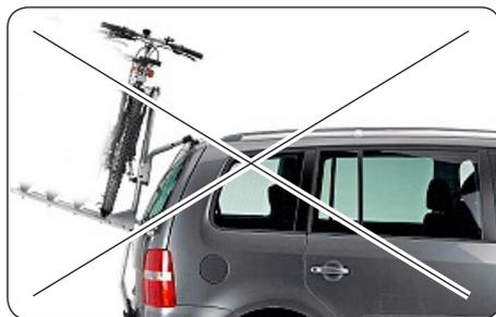
**!** Queda completamente prohibido el uso de porta bicicletas ya que puede causar daños a los componentes de seguridad de la bicicleta EPAC. La avería de dichos componentes puede provocar situaciones de peligro, caídas, accidentes y daños a cosas.
