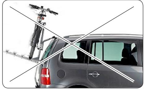
**!** Von der Nutzung eines Fahrradträgers wird dringend abgeraten, da dieser die Sicherheitskomponenten des Fahrrads beschädigen könnte. Schäden an diesen Komponenten können zu gefährlichen Fahrsituationen, Stürzen, Unfällen und Schäden an Gegenständen führen.
