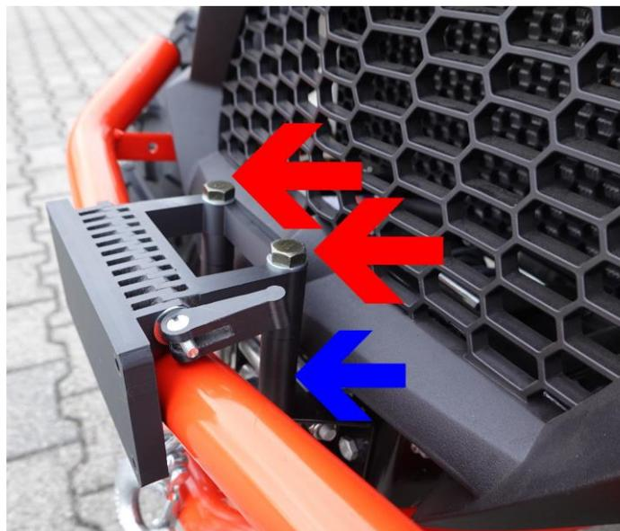
2. Positionieren Sie den Kennzeichenhalter über die originale Stoßstange und führen Sie die zwei Abstandsbuchsen zwischen Kennzeichenhalter und Seilwindenfenster (blauer Pfeil).
